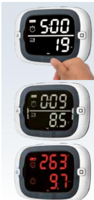
Beim Vorbereitungssignal drücken Sie auf die "GUN" Taste und der Countdown beginnt. Bei jedem weiteren Signal können Sie den Countdown synchronisieren indem Sie nochmals auf "GUN" drücken.
