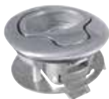
Einlassring mit Verschluss Aus rostfreiem Stahl Ø über alles 62 mm, Einbaudurchmesser 50 mm, Türdicke 11-20 mm. Befestigung mit 4 Schrauben Ø 5 mm
