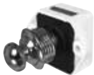
Runder Druckverschluss verchromt Einbaudurchmesser 20 mm, Türdicke 10 – 15 mm, Einbautiefe 20 mm.
