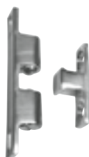
Schnappverschluss Aus rostfreiem Stahl 316 Befestigung: 4 Schrauben Ø 3 mm
