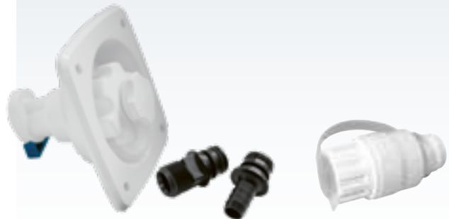
Einbau-Wasserdruckregler aus weissem Kunststoff für Gartenschlauch mit 3/4" Gewinde. Ausgang mit Schnellanschlüssen für Schlauch von Ø 13 mm und 1/2" Gewinde. Mit Filter ausgerüstet. Grundplatte 111 x 111 mm, Ausschnitt Ø 88 mm
