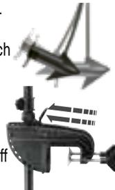
Die Pinne ist um 15 cm teleskopisch ausziehbar um Richtung und Geschwindigkeit zu kontrollieren.
