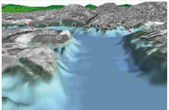
Affichage à l'écran de la bathymétrie et du relief terrestre en 3 dimensions, avec possibilité de superposer des photos de la zone à l'image sélectionnée.
