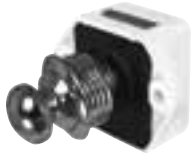
Loquet à poussoir chromé Diamètre de perçage 20 mm, épaisseur porte 10 à 15 mm, profondeur derrière la porte 20 mm.
