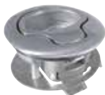
Anneau à cuvette avec loquet En acier inox Diamètre hors tout 62 mm, diamètre de perçage 50 mm, épaisseur porte 11-20 mm. Fixation : 4 vis Ø 5 mm.
