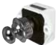
Loquet à poussoir chromé Diamètre de perçage 20 mm, épaisseur porte 10 à 15 mm, profondeur derrière la porte 20 mm.
