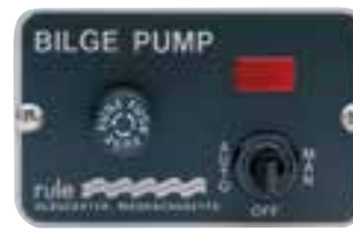
Interrupteur de commande automatique 3 positions : Automatic, Manual et Off. Avec porte-fusible et témoin de fonctionnement, 12 V. Dimensions : 82 x 50 mm
