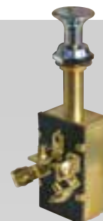
Interrupteur à tirette à 3 pôles Max. 20 A, tige 9 mm, pour paroi max. 22 mm
