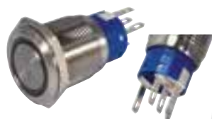
Interrupteur et bouton-poussoir avec éclairage LED En acier inox, 12 V / 5 A. LED de fonction ou pour éclairage en continu. Dimensions : Ø 19 mm x 33 mm
