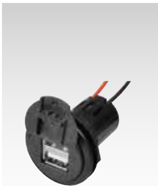
Prise USB encastrable 12/24 V Ø de montage : 27.8 x 39 mm Charge admissible : 5 V, 2 x 2500 mA Tension d'entrée : 8-28 V
