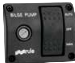
Interrupteur de commande automatique 3 positions : Automatic, Manual et Off. Contacteur avec porte-fusible et témoin de fonctionnement. Retour automatique de Manual à Off. Dimensions : 75 x 61 mm
