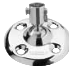
Platine à rotule En acier inox Fixation par 4 vis de Ø 5 mm Axe : Ø 4.8 mm Ø 55 mm Hauteur : 32 mm
