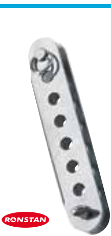
Latte de ridoir à 7 positions En acier inox Longueur 108 mm, axe 6.4 mm Ajustable de 12 à 90 mm
