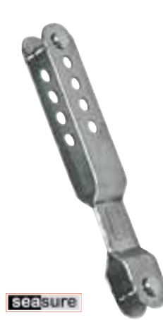
Latte de ridoir à 5 positions En acier inox Longueur 112 mm, axe 4.8 mm Ajustable de 60 à 95 mm
